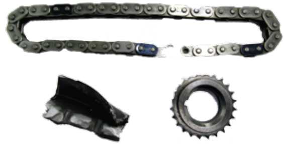
Imagen 2. Estiramiento de la cadena y componentes desgastados
