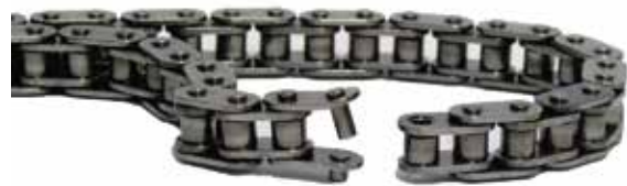
Imagen 4. Rotura de la cadena
