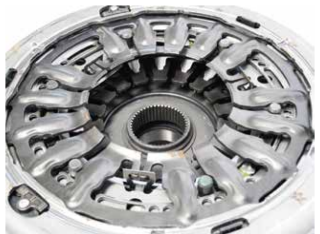
Imagen 7. Conjunto doble embrague lado caja
