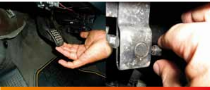
Figura 4. Procedimiento correcto: Al levantar el pedal se libera la carga y nos permite ajustar fácilmente el mando, tal como se muestra en la imagen.
