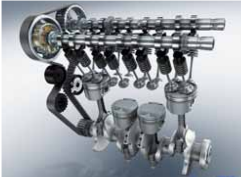
Imagen 3: Motor con doble árbol de levas
