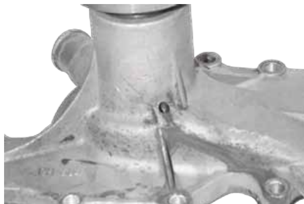
Imagen 5. Bomba de agua con fuga por el orificio de desfogue
