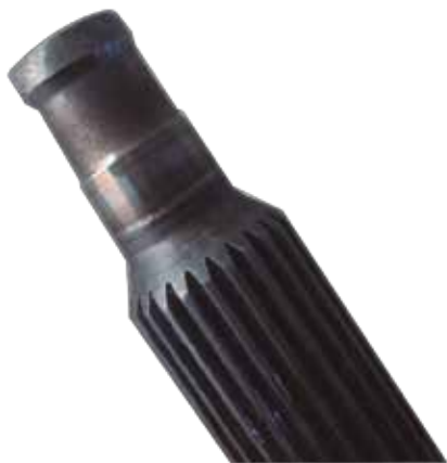
Imagen 2. Eje propulsor con desgaste.
