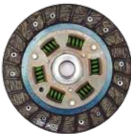
Imagen 3. Disco con cara de fricción en fibra de vidrio con coeficiente de fricción relativamente bajo 0.3
