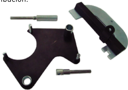
Imagen 5. Herramienta especializada utilizada para el cambio del kit de distribución KD049 – KD050
